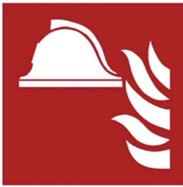
F004 Mittel und Geräte zur Brandbekämpfung
