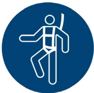
M018 Auffanggurt benutzen
