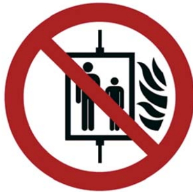
P020 Aufzug im Brandfall nicht benutzen
