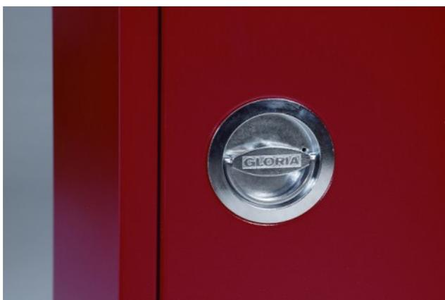
Alle Wandhydranten sind mit vertieft liegenden Drehgriffen gemäß DIN 14461-1 bzw. -6 ausgestattet, die aus Zink-Druckguss bestehen und für eine bessere Optik zusätzlich verchromt sind.
